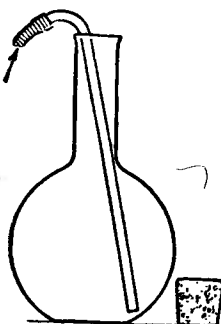
Рис. 97. Наполнение колбы углекислым газом.
