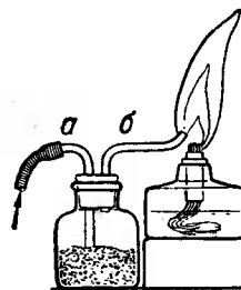
Рис. 325. Введение порошка в пламя спиртовки.
