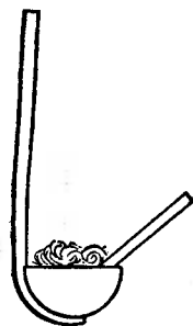
Рис. 32. Спичка для зажигания кальция в кислороде.
