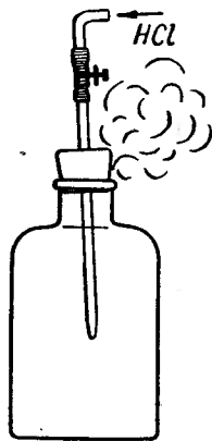
Рис. 149. Наполнение склянки хлористым водородом для опыта с фонтаном.
